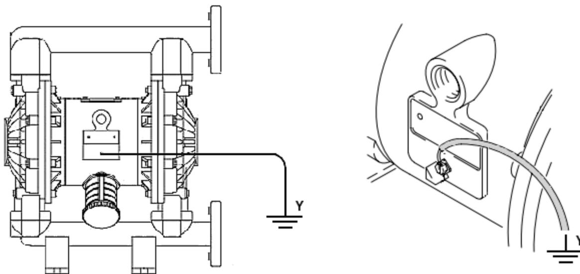
Рисунок 5. Заземление насоса
