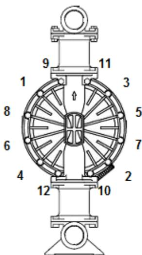
Рисунок 7. Очередность подтяжки болтовых соединений основных рабочих камер.
