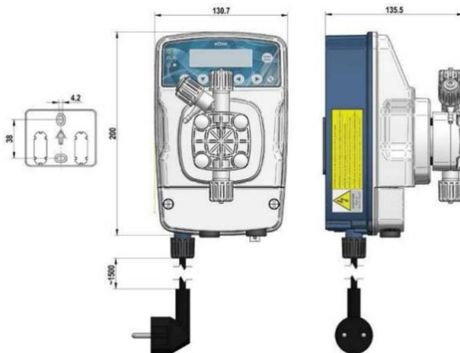
Рис. 1 – Насос и пластина настенного крепления (размеры в мм)
