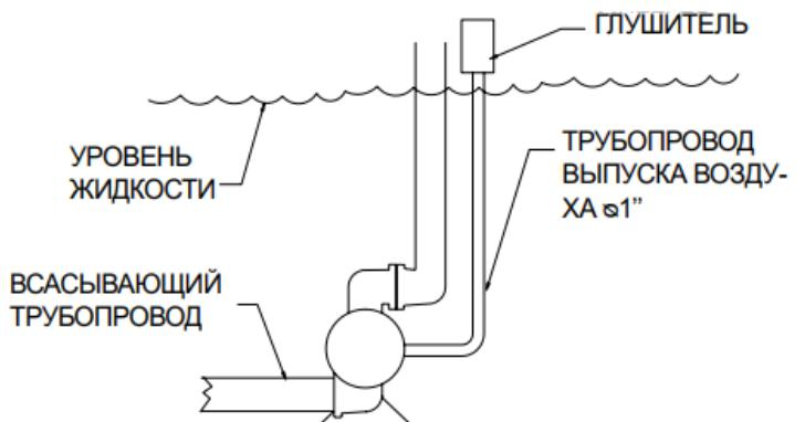
Погружное применение насоса возможно, если материалы, из которых он изготовлен, совместимы с перекачиваемой жидкостью. Труба для выпуска воздуха должна располагаться выше уровня жидкости. Если источник перекачиваемого продукта располагается выше уровня насоса (такое расположение используется при заливке всасывающей линии), для предотвращения сифонирования трубы выпуск воздуха следует установить выше уровня источника жидкости.
