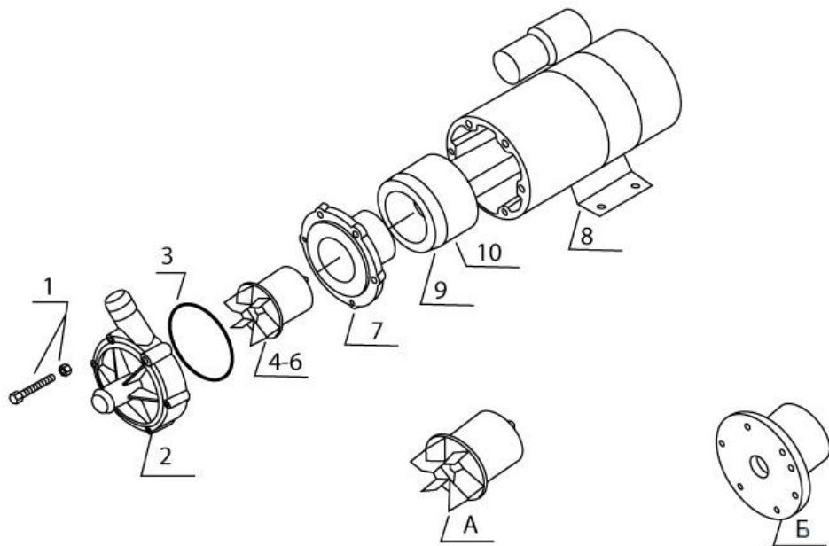
1. Болт с гайкой (Нержавеющая сталь)
