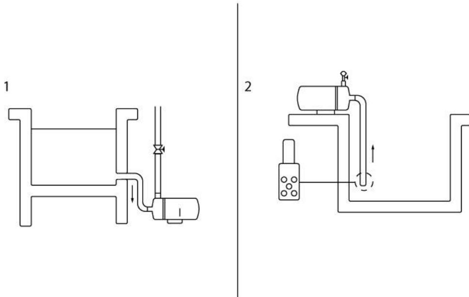
На первом изображении показан монтаж насоса с положительным подпором на всасывании. Жидкость поступает в насос самотеком.
