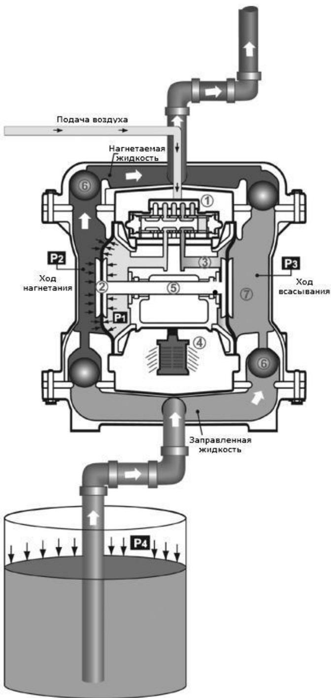
Пневмоприводные двухмембранные насосы приводятся в действие сжатым воздухом, азотом или другим не агрессивным газом.
