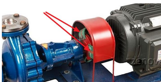
Изображение 1. В муфте двигателя насоса RY применяются гибкие ремни.
