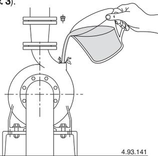
Рис. 3 Заполнение жидкостью
