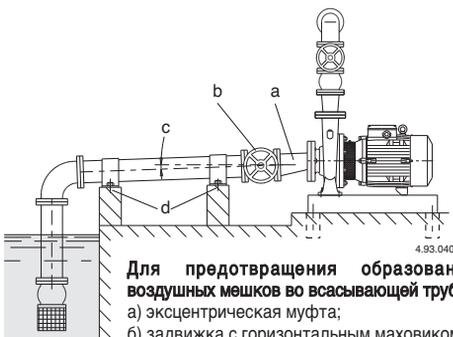
**Для предотвращения образования воздушных мешков во всасывающей трубе:**
