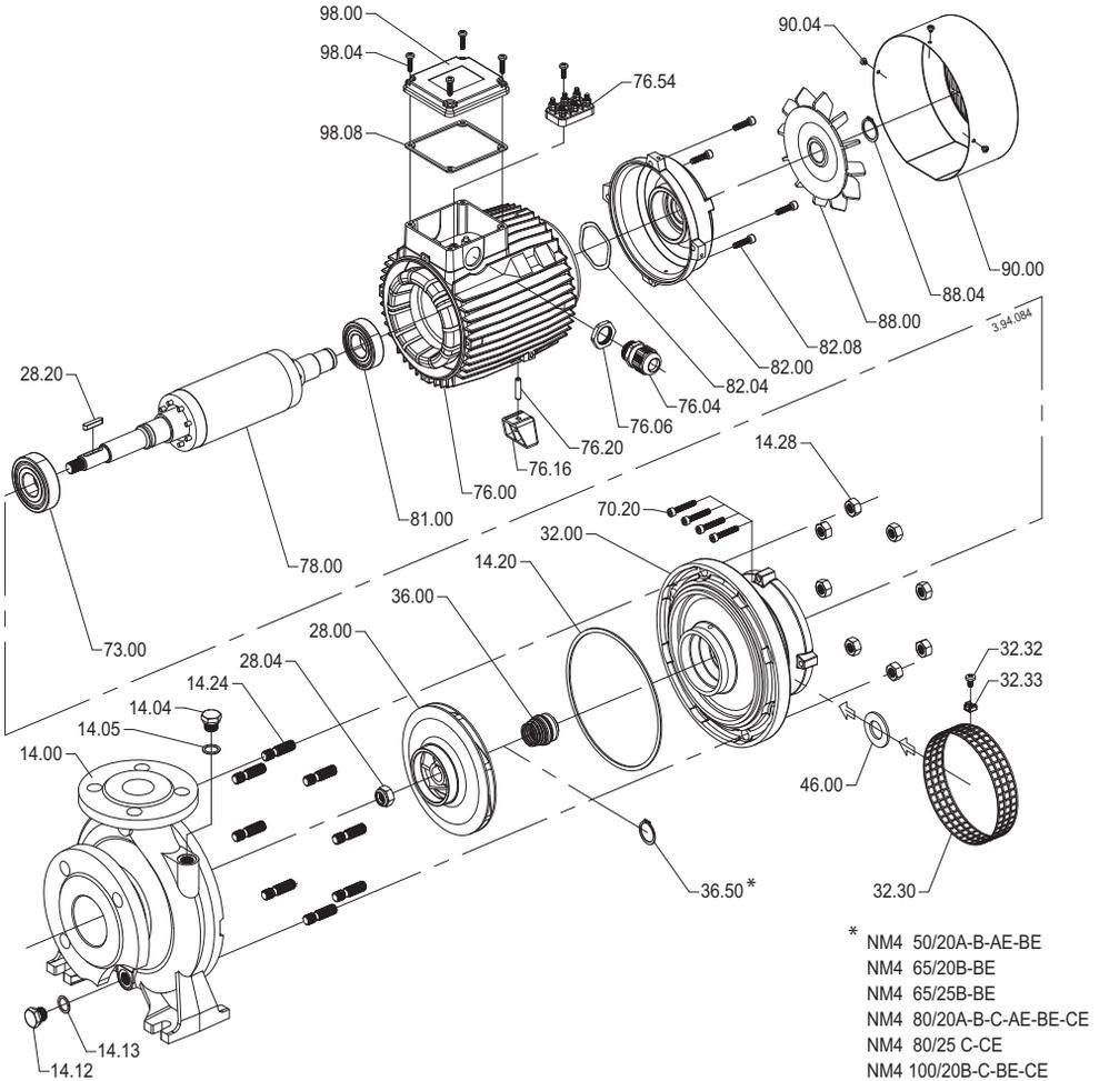
Чертеж для демонтажа и сборки
