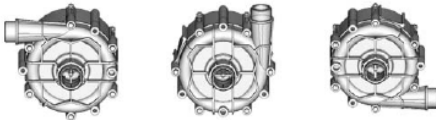
Рис. 8.3.1 В - Допустимое положение гидравлического блока
